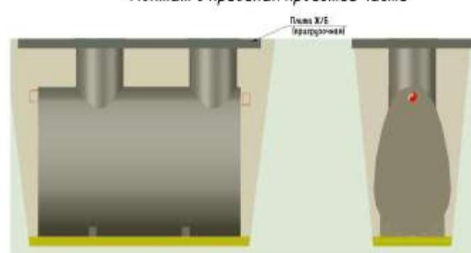
*Монтаж вне пределах проезжей части с низким уровнем грунтовых вод.*
